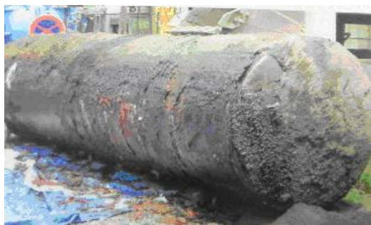
(腐食した地下貯蔵タンクの写真)
