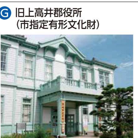
大正6年新築の擬洋風建築です。玄関上のテラスやその上部の切妻破風、上げ下げ式のガラス窓などパロック様式の特徴をよく伝えています。
