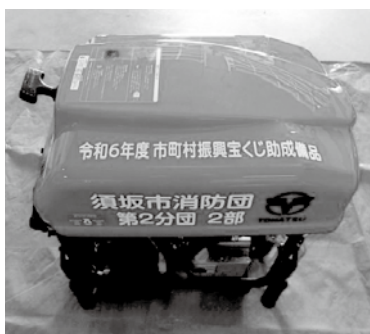
▲小型動力消防ポンプ
