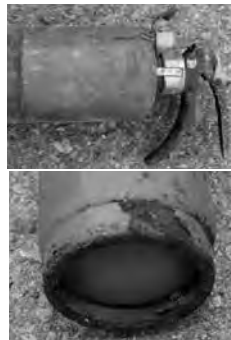
▲古い消火器の例
