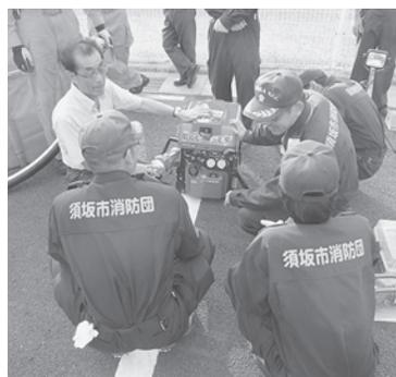
九月二十日、五分団二部(新田町)にC1級可搬ポンプが配備されました。夜間でも的確な操作をするために操作部にLED照明とセルスタターを内蔵しています。また環境に配慮し排気ガスの削減・低騒音・低燃費のポンプとなっています。コンパクトで扱いやすく女性でもスムーズな持ち運びが可能です。
