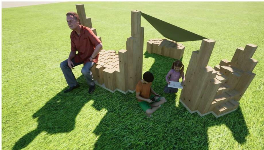
中心の大ベンチに基礎を打ち中ベンチと小ベンチは位置を動かして使えるようにする。両端の高さがあることで布をはって日陰を生み出すことができる。
