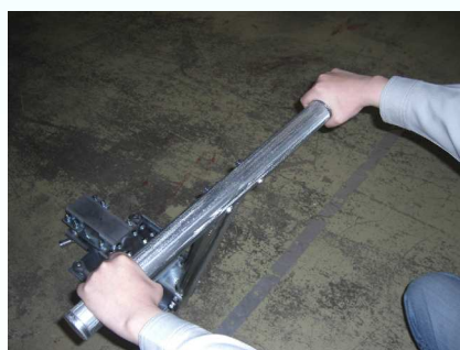
重荷重牽引向け大型センサーハンドル (自在キャスター舵取機構付)
