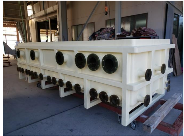
↑ FRP製タンク
