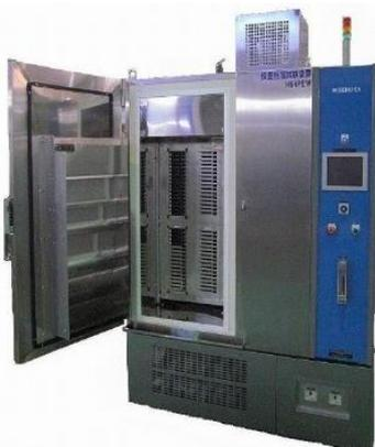
←<HDD/SSD 恒温恒湿試験装置>
