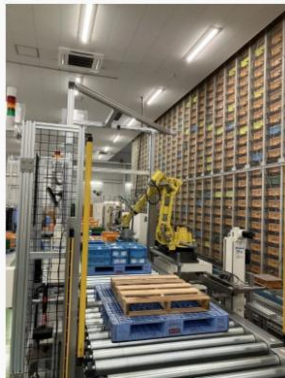
ロボットアームによる自動搬送
