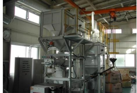
ガス硬化型砂再生装置、連続ミキサー
