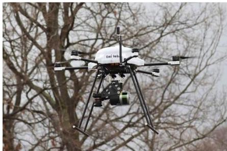
近年、測量や土木分野においてニーズが高まっている UAV レーザー計測に対応するため、新開発した UAV。レーザースキャナーとカメラを搭載し、約 20 分間の飛行が可能です。プロペラやアームを工具無しにコンパクトに折り畳むことができるため、保管や運搬時にも広いスペースを必要としません。
