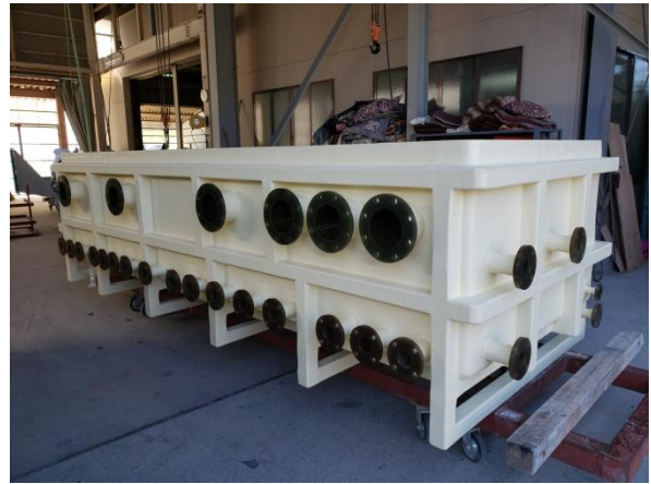
↑ FRP製タンク
