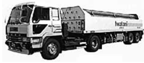
図 3-41 水素ポンベのトレーラーによる輸送
